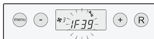
Sperrender Systemventilatorcode; Störungsanzeige blinkt, Beleuchtung Ein
