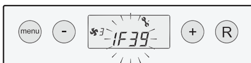
Sperrstörung; Ventilatorstörung; Störungsnummer blinkt
