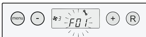
Sperrender Gerätecode; Störungsanzeige blinkt, Beleuchtung Ein
