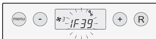
Dérangement verrouillant ; dérangement du ventilateur
